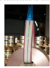
Der schnittfeste Schutzschlauch liegt fest an der Kante an, das textile Hebeband läuft durch den Schutzschlauch, es gibt keine Bewegung an der scharfen Kante durch Banddehnung und Lastpositionierung. So kann der Schutzschlauch bei einseitigem Herausziehen mit dem Kran nicht mehr verloren gehen, da er mit dem Hebeband fest verbunden ist.
